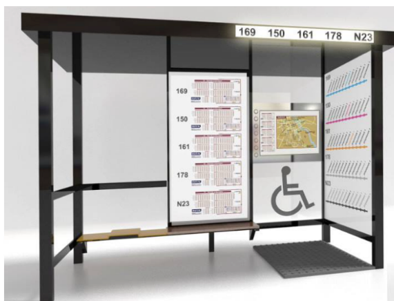
Rys. 10. Projekt wiaty przystanku ogólnodostępnego (autorzy: Borzymiński M., Cabalska A., Łakomska A.). Powierzchnia przystanku podzielona na strefy dla sprawnych i niepełnosprawnych; zastąpienie
